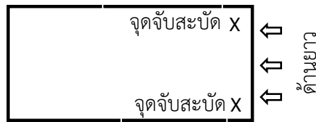
รูปที่ 6 ตัวอย่างตำแหน่งการจับบริเวณปลายชิ้นทดสอบ (ข้อ 9.2.1.2 (2))
